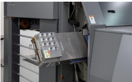
收纸部 LED-UV 干燥装置
