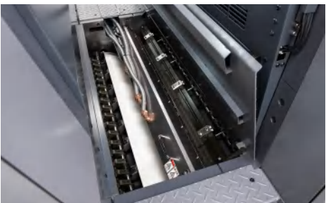
压印滚筒上方色组间 LED-UV 干燥装置
