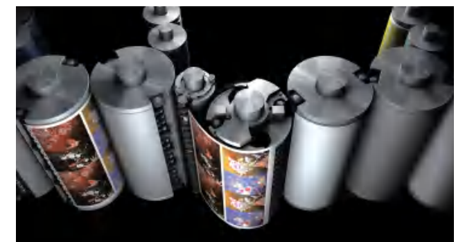
双倍径滚筒 - 双倍径滚筒 - 单倍径滚筒翻转机构(8色、10色单双面两用机上配备)* ※ 2色-6色机单倍径滚筒 - 双倍径滚筒 - 单倍径滚筒是标配。双倍径滚筒 - 双倍径滚筒 - 单倍径滚筒为选配
